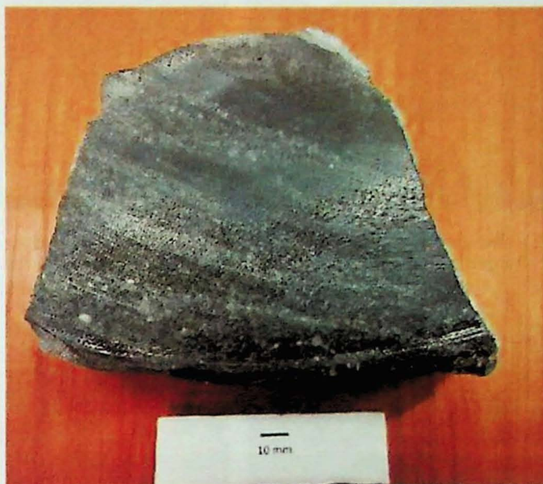
Figura 6.16 – Aspecto macroscópico típico dos andesito bandados da Formação Bom Jardim, com leitons microporfíricos (Amostra NP-302). As porções verdes escuras e mais finas correspondem a zonas onde a alteração hidrotermal propilítica foi mais intensa.
