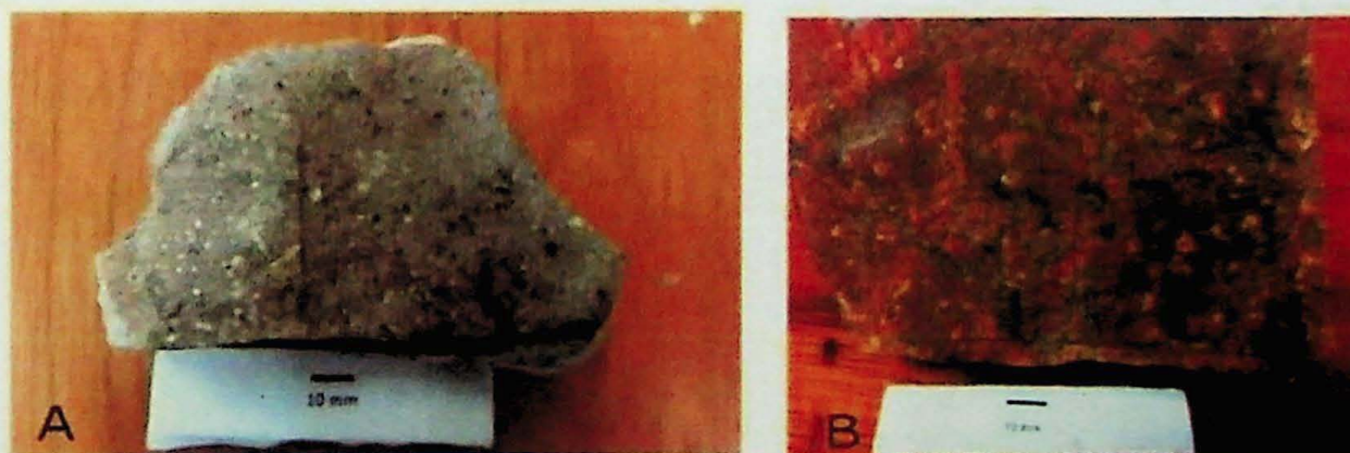
Figura 6.11 – A) Aspecto comum dos riolito porfíricos (amostra NP-297C). B) Riolito porfírico intensamente fraturado e hidrotermalizado (amostra NP-353).
